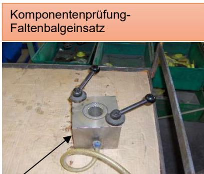
Prüfeinrichtung für Faltenbalgeinzelnprüfung
