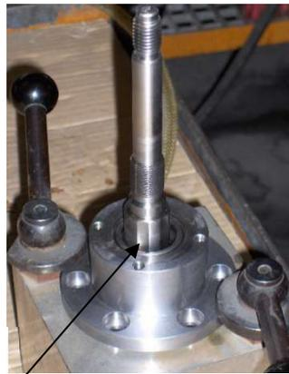
Faltenbalg wird 6bar(g) Außendruck Beaufschlagt
